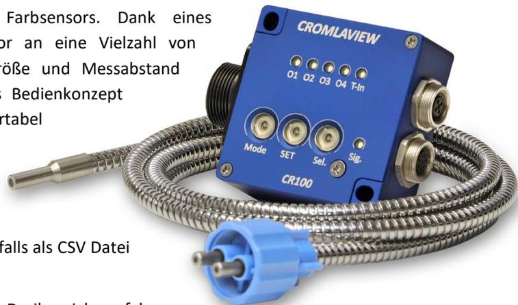
Die Funktionsweise des CR100 basiert auf dem Dreibereichsverfahren. Dabei wird das Messlicht mit den Normspektralwertfunktionen bewertet und den drei Wellenlängenbereichen rot, grün und blau zugeordnet. Durch die Bewertung mit den Normspektralwertfunktionen ist der Sensor in der Lage, Farben wie das menschliche Auge zu erkennen.
