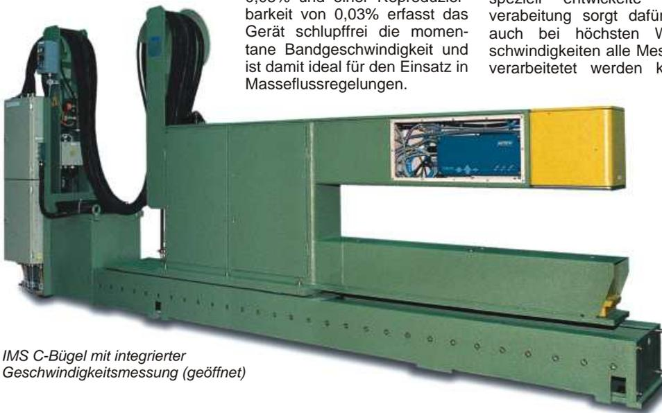
IMS C-Bügel mit integrierter Geschwindigkeitsmessung (geöffnet)
