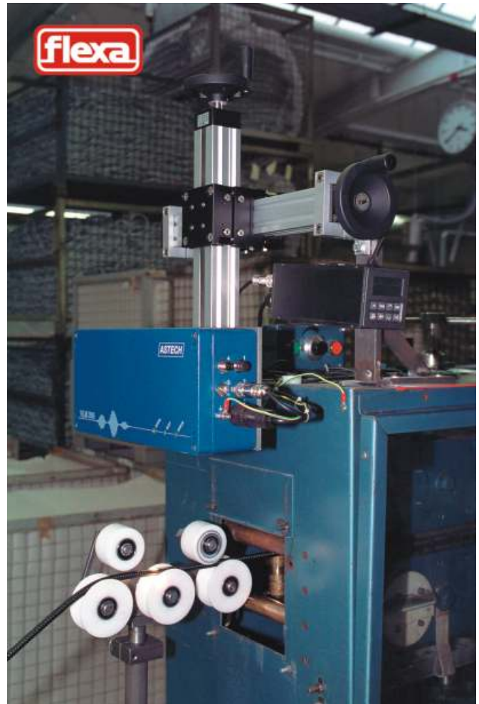
VLM 200 A - Längenmessung für Konfektionierung
